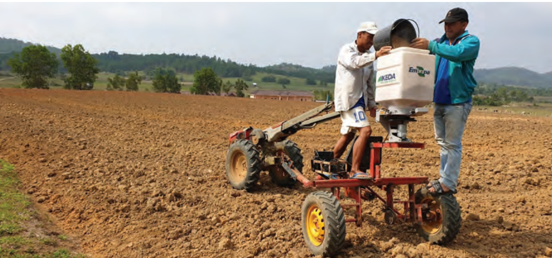
ຮູບ 14: ເຄື່ອງຫວ່ານເມັດພັນ ແບບໃຊ້ກັບລົດໄຖຢ່າງຕາມ ແລະ ແບບໃຊ້ແຮງຄົນ.
